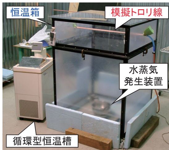
着霜再現試験装置 (装置全体を雪害防止実験所の低温室内に設置)
