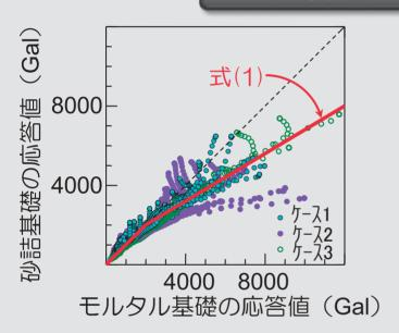
th別基礎電化柱から砂詰基礎電化柱 への応答加速度の換算式
