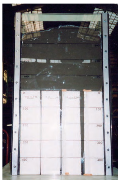
模擬クラック 注入実験結果
