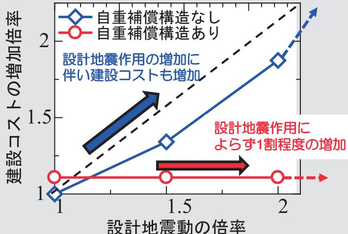
設計条件：地震作用に対して倒壊させない
