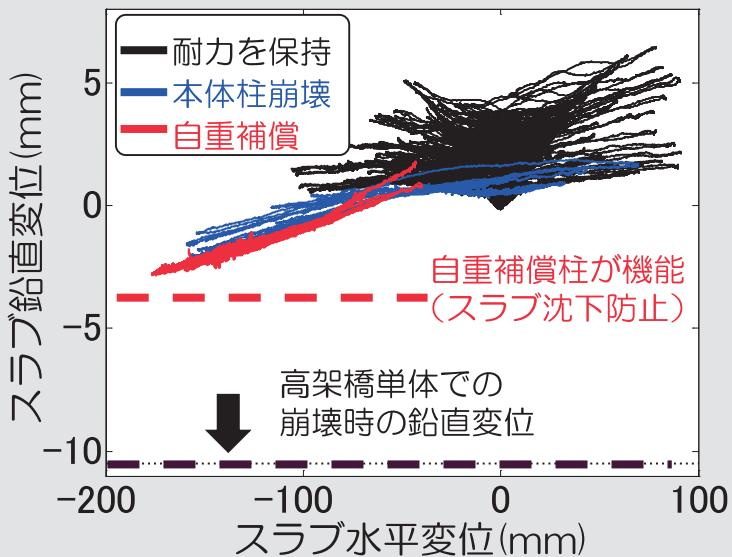
高架橋模型の振動台試験による効果検証
