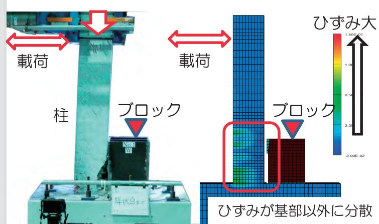
1/2.5柱の載荷・FEMによる耐力評価
