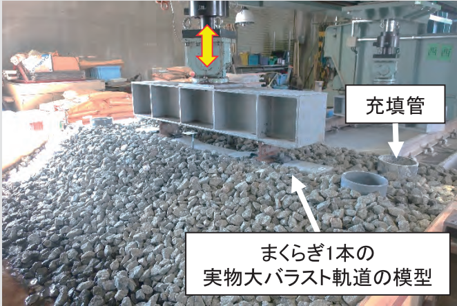
繰返し載荷試験の状況
