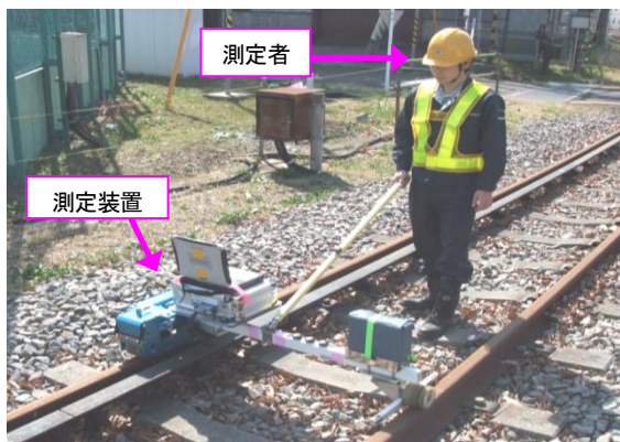
写真1 総研式レール凹凸連続測定装置での測定状況の例
