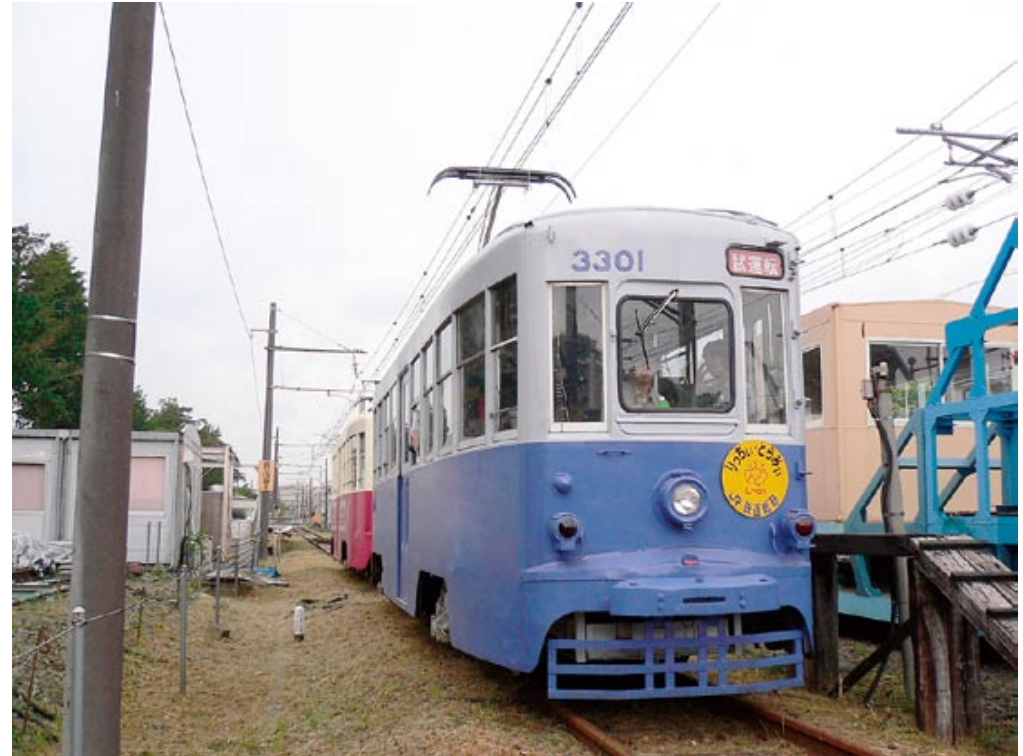
図 直流1500V架線下での架線ハイブリッド走行試験
