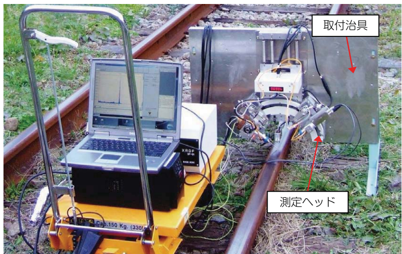
図 XRDFによるレール測定状況
