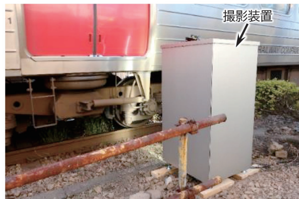
図5 試作した撮影装置による撮影試験
