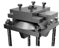
図5 鋼製支承の例 (支承板支承)
