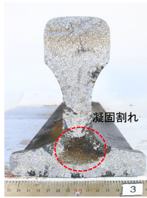
図4 凝固割れの破断面
