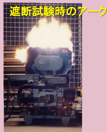
図2 直流高速度遮断器の試験の様子
