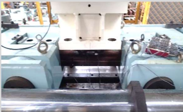
レール曲げ疲労試験の実施状況
