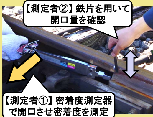
図1 鉄片を用いた密着度測定
