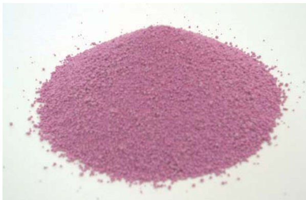
図3 BLITS工法用路盤安定材RKB-999R
