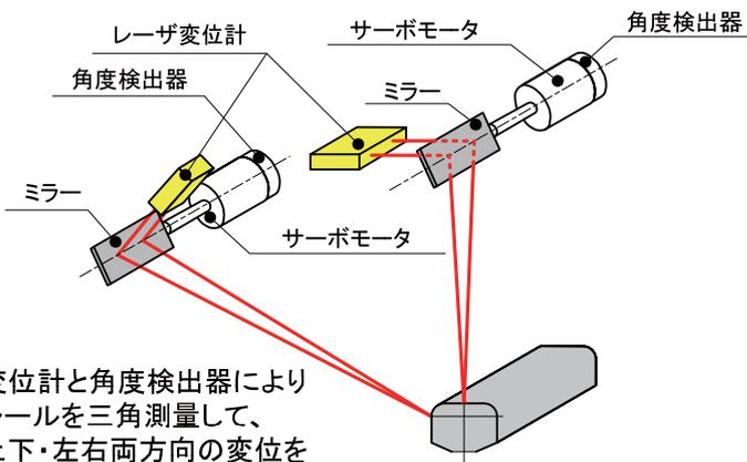
変位計と角度検出器によりレールを三角測量して、上下・左右両方向の変位を同時に求めます。
