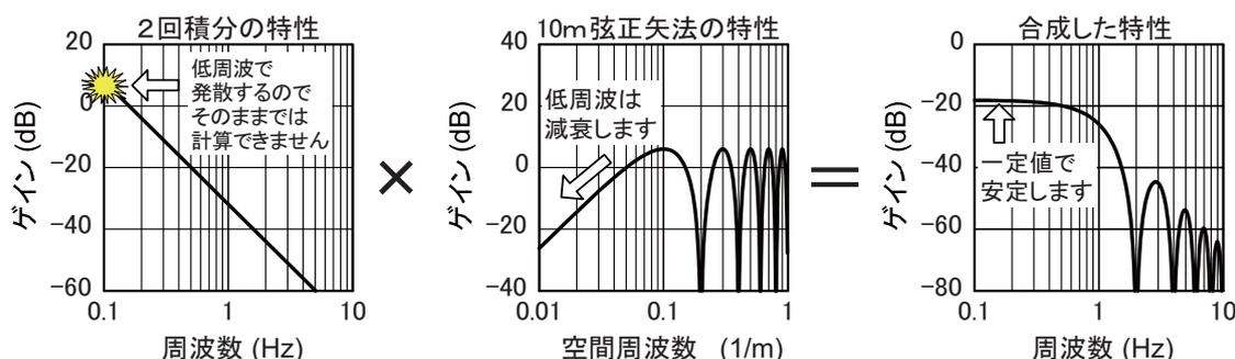
右端の図に示すように「慣性正矢法」は安定した演算ができ、しかも出力が正矢法と同じ波形になります。
