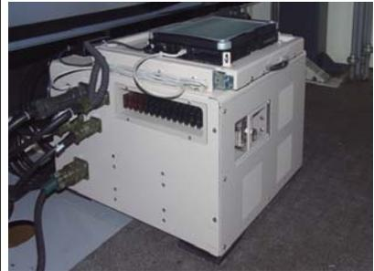
写真の機器箱は「電源ユニット」で、「収録ユニット」はその上に載せた、小型パソコン1台のみで構成しています。
