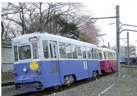
中古トラム2両連結による走行試験 (パンタグラフを順次降下しながら バッテリー走行へ移行中)
