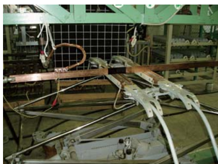
パンタグラフすり板の 定置連続通電試験
