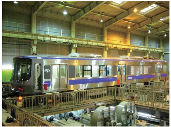
図3 車両試験台による高速走行試験
