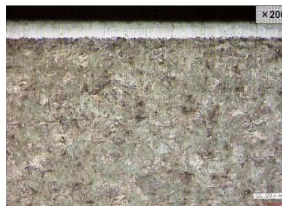
図3(b) 作成した白色層模擬試験片
