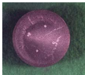
金属含浸バルク磁石 (孔にアルミを挿入し低融点金属で含浸)
