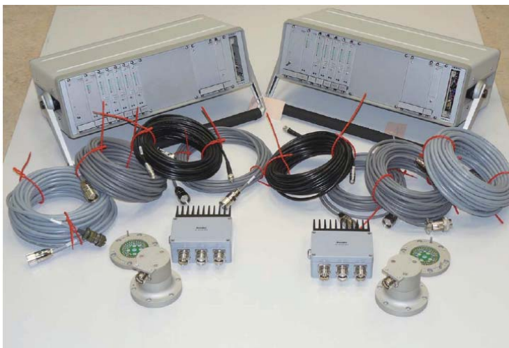
1軸分のPQ測定用テレメータ装置一式
