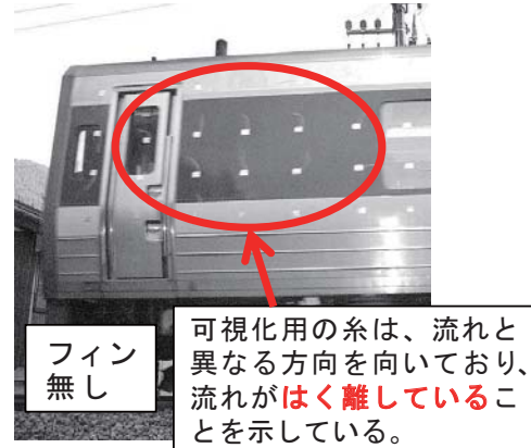
図3 はく離抑制用フィン (営業線試験)
