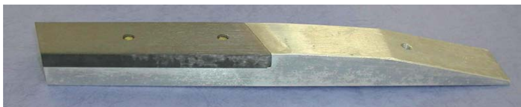
複合補助すり板（C/C複合材製カーボン系すり板をアルミ合金補助すり板にねじ止めした補助すり板）
