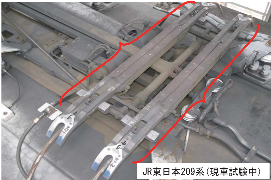
主すり板・補助すり板の全てがC/C複合材製カーボン系すり板
