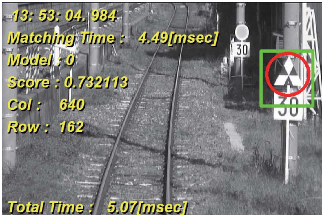
システムが徐行予告信号機を検知した様子
