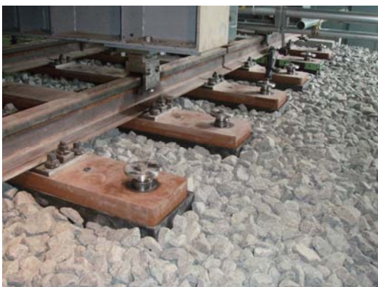
自動沈下補正まくらぎの 実物大模型試験
