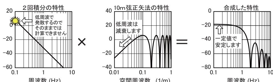
右端の図に示すように「慣性正矢法」は安定した演算ができ、しかも出力が正矢法と同じ波形になります。
