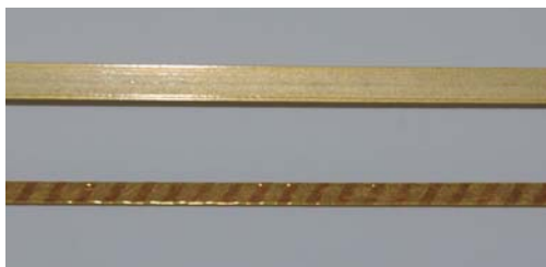
ビスマス線材 (鉄道車両用主変圧器用) 既存の線材 (上) と低交流損失線 (下)
