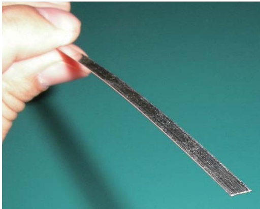
希土類系高温超電導線材外観 (幅4.4 mm、厚さ0.2 mm)
