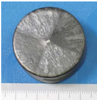
製造した超電導バルク体 (ガドリニウム系、直径34mm)
