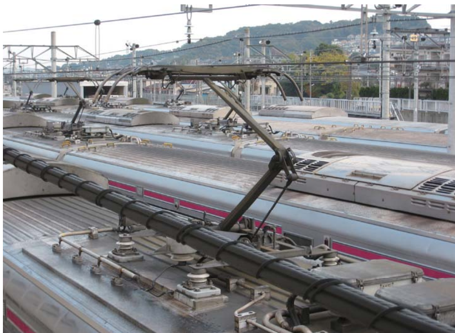
高強度C/C複合材製カーボン系すり板と高強度ボルト を装着した舟体を装着した8000系車両のパンタグラフ (京王電鉄(株)高幡検車区にて撮影)
