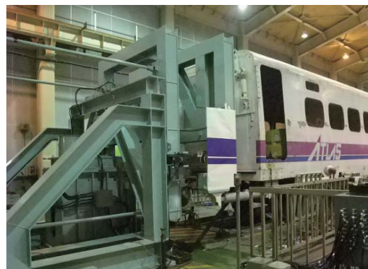
図3 供試車両との連結状況
