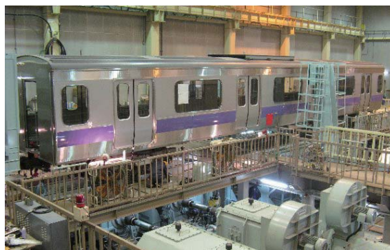
車両試験台における実車の加振試験
