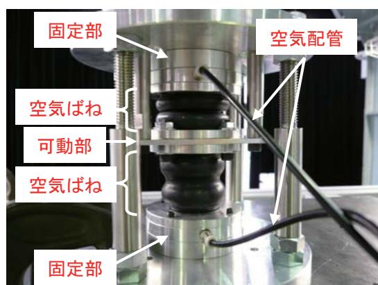
上下に対向配置した空気ばねの空気圧を変化させることによって剛性が変化する
