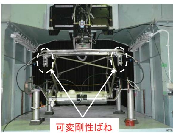
可変剛性ばねの空気圧制御により追隨振幅のピーク周波数が変化
