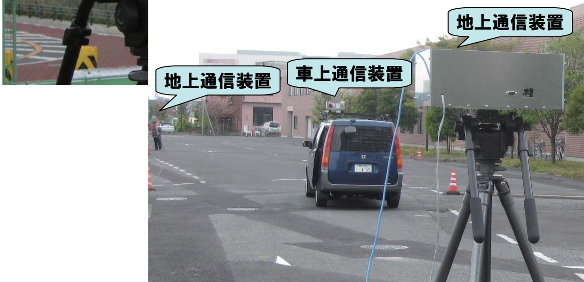
自動車を用いた通信試験
