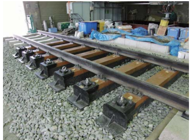
自動沈下補正まくらぎ (第二次試作)
