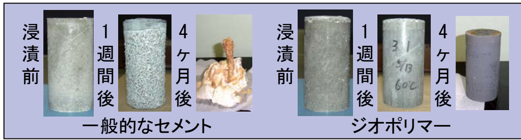
図4 10%硫酸浸漬試験
