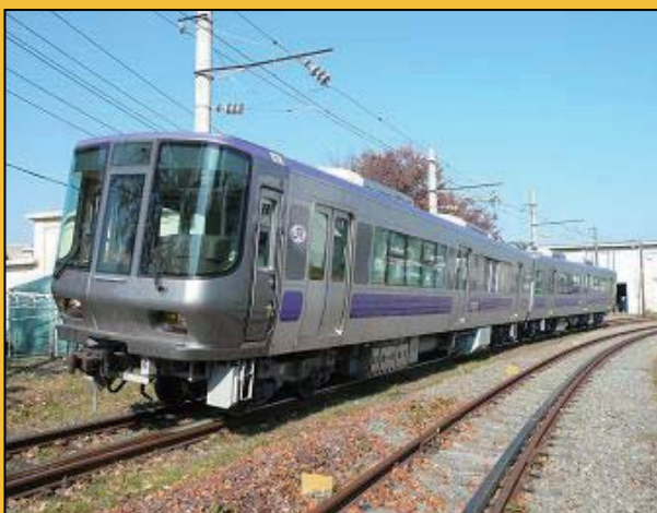
図1 燃料電池・バッテリー ハイブリッド試験車両（2両編成）
