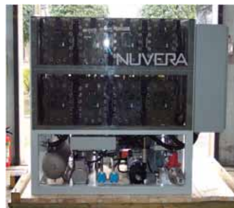
100kW級燃料電池システム（車載）
