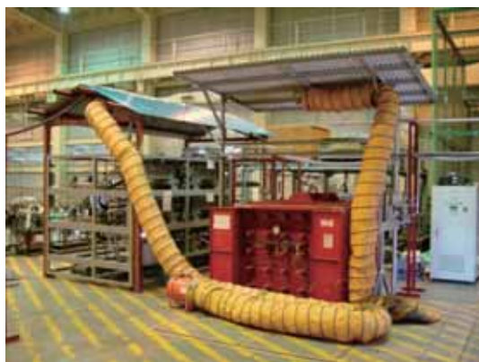
30kW級燃料電池システム（定置）
