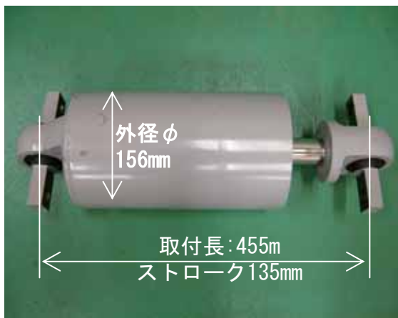
新幹線用地震対策左右動ダンパ 試作品、外観と寸法例
