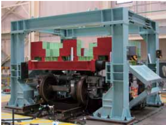
振動台実験(左写真)で中越地震推定地震動により効果を実証(右図)
