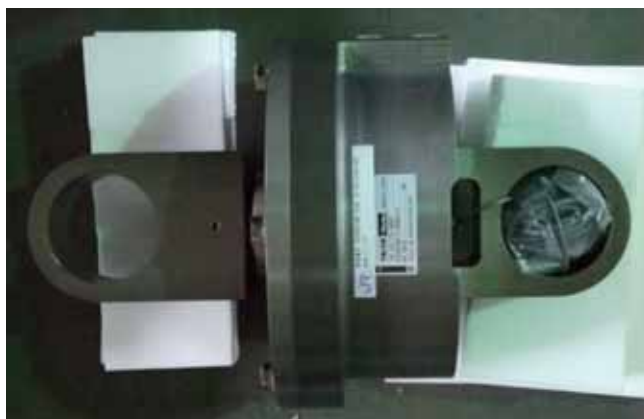
図1 タンデムシリンダ式操舵アクチュエータの外観
