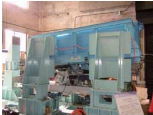
図4 実物大の振り試験装置 (動揺負荷試験装置)
