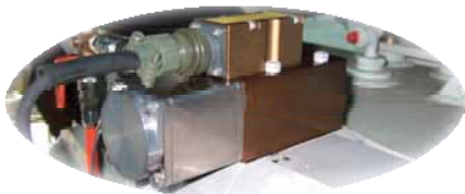
図1 新しいサーボ弁(流量比例制御弁)
