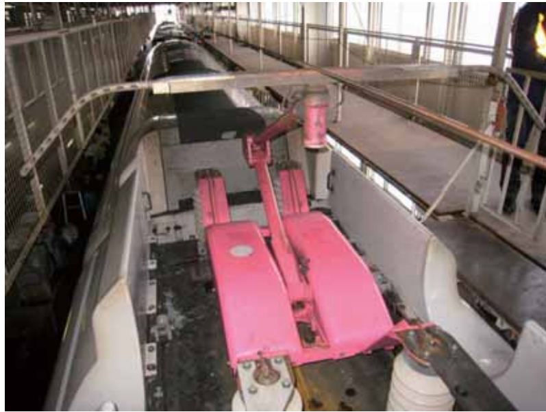
図2 新しい潤滑成分を用いた新幹線用焼結合金すり板を搭載した新在直通新幹線車両のパンタグラフ
