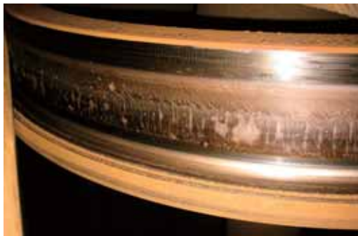
図1 実車における車輪踏面熱き裂の例
