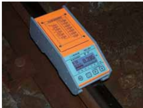
軌道回路レール電流検出器外観
