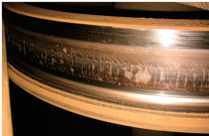
図1 実車における車輪踏面熱き裂の例
