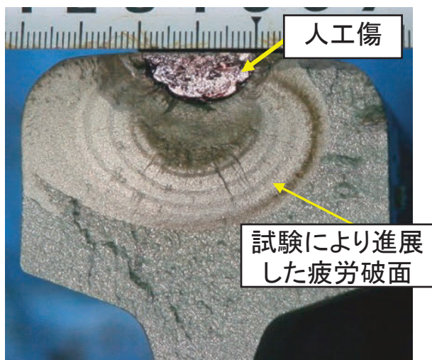
頭部横裂のき裂進展試験の破断面
