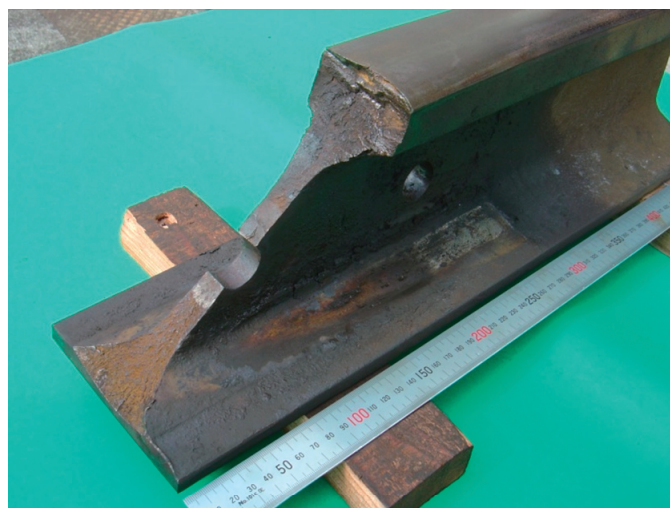
継目穴のき裂進展試験後の破断面
