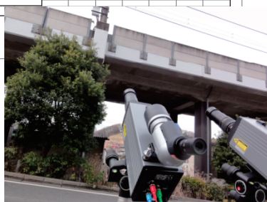
Uドップラー 注) による振動測定
