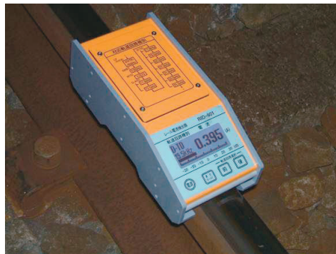
軌道回路レール電流検出器外観
