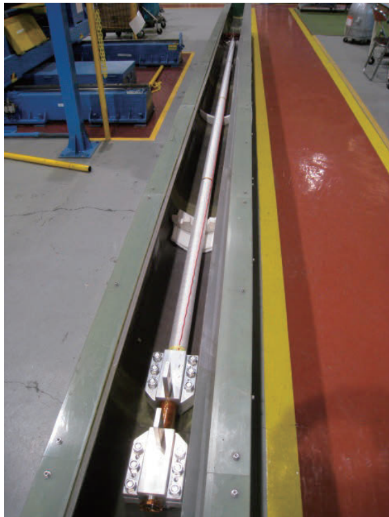
鉄道用超電導ケーブル (外観と断面図)
