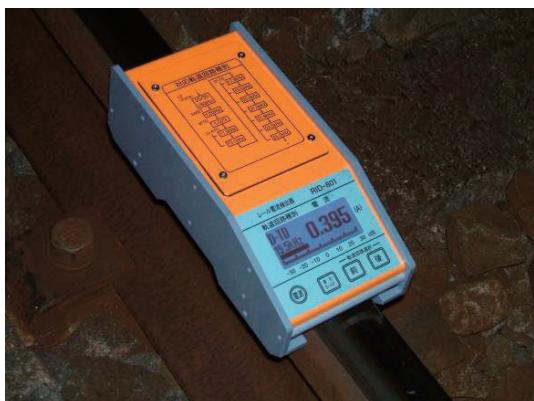
軌道回路レール電流検出器外観
